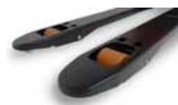
800 mm-markering på gafflar för att undvika att pallar skadas när de hanteras på tvären. Stabilitetshjul och inträdesrullar.
